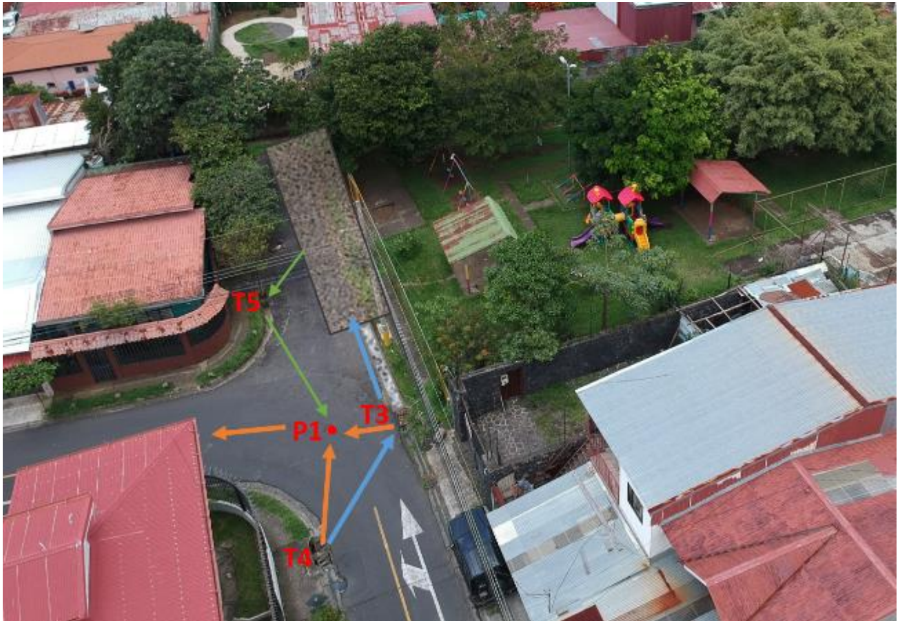
Figura 1.2 Esquema del funcionamiento adaptado del Prototipo 1. Flechas azules muestran el flujo de agua pluvial, flechas naranjas muestran el flujo de agua gris y flechas verdes muestran el flujo de alivio de excesos en casos de lluvia extrema.
