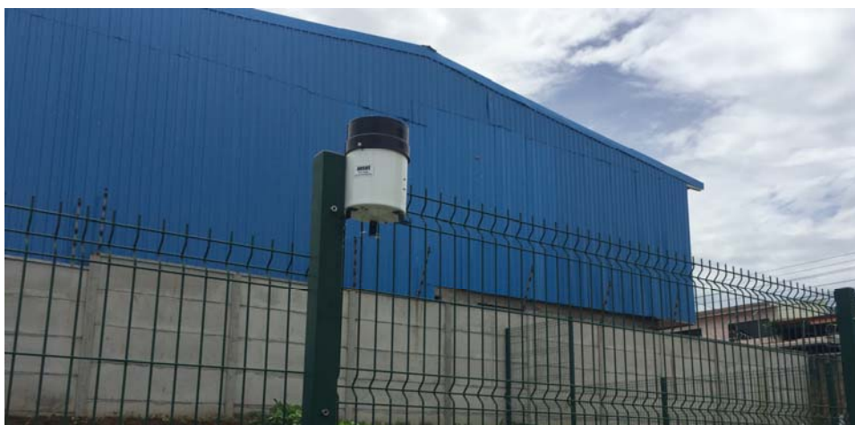
Figura 7: Estación pluviométrica Hobo con resolución de 0.2mm instalada en CECUDI El Rosario en junio 2019
