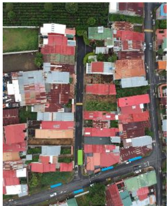
Figura 2.6 Sitio propuesto para la implementación del área de infiltración en un carril de la calle, rectángulo verde. Los rectángulos azules muestran las áreas de bio-filtración y tratamiento.
